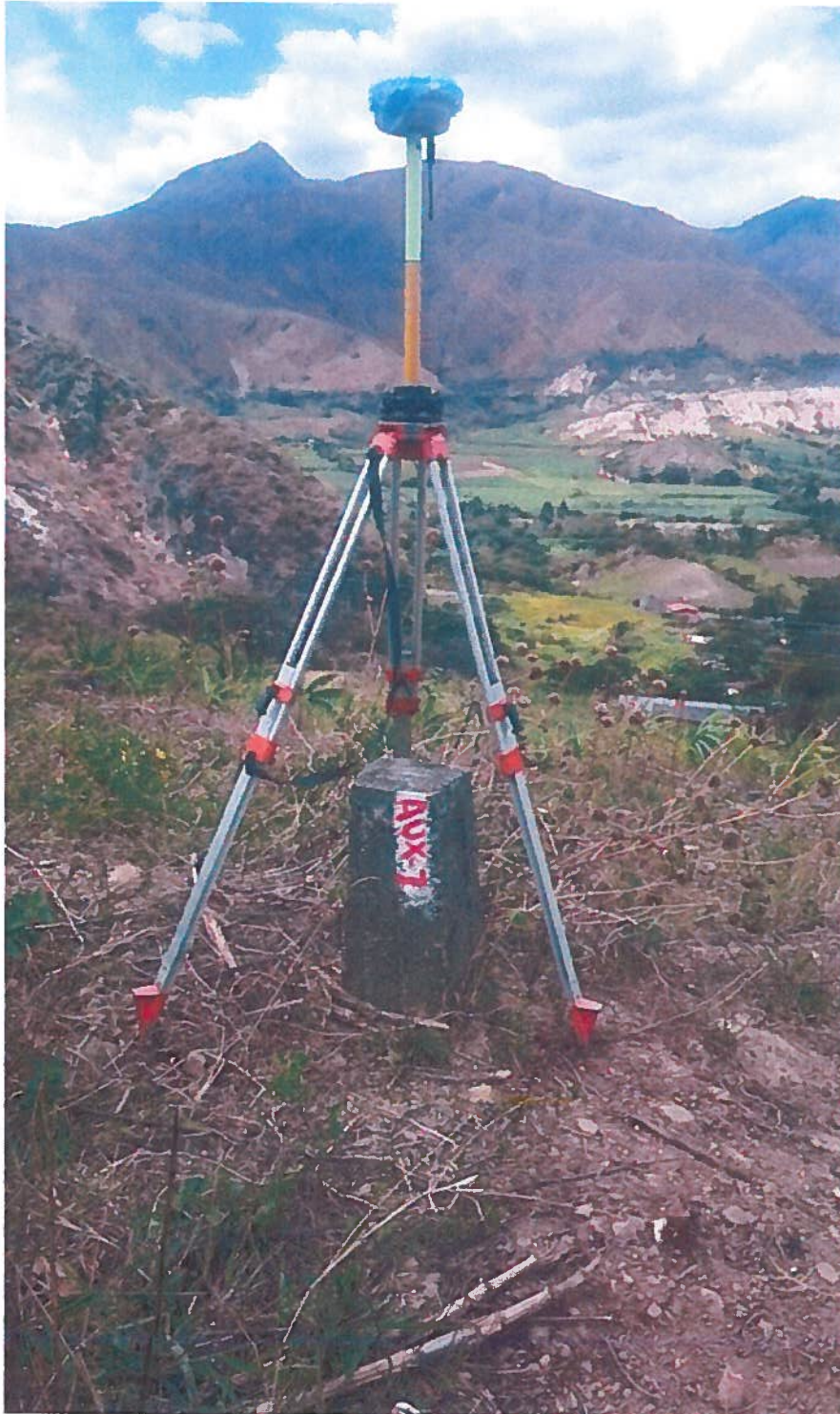
Foto 1. Punto de control fijado por DIDRENSUR EP para el levantamiento topográfico en el sistema de riego Quinara
